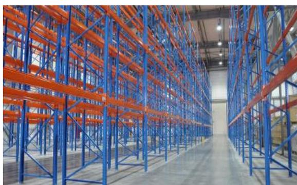
**Каркасные стеллажи** состоят из многочисленных уровней рам с горизонтальной обрешёткой. Такие стеллажи предназначены для складирования товаров исключительно на поддонах или в специальной таре по стандарту.
